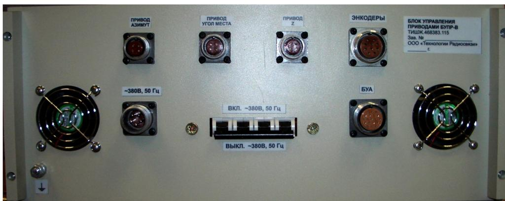
Рисунок 1.1 б – Внешний вид БУПР со стороны задней панели
